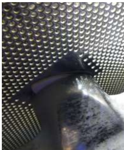
Рисунок 3. Уплотнение лопасти коатера
