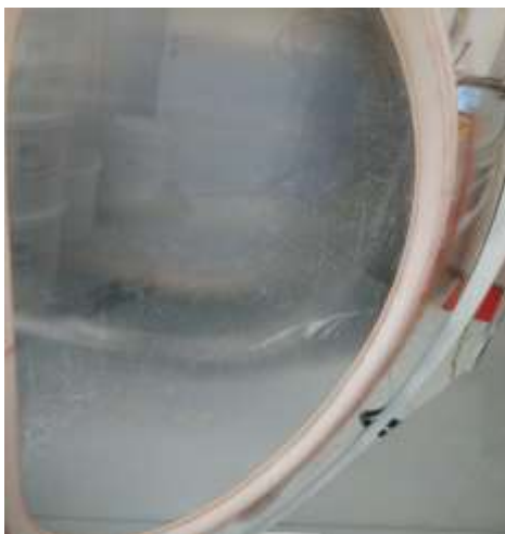
Рисунок 2. Уплотнение иллюминатора коатера
